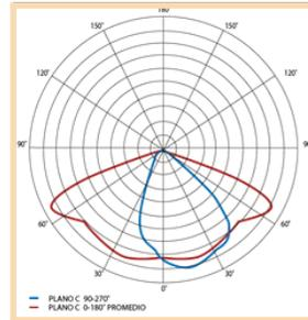
Curva modelo tipo, no específica, ni única para este modelo de luminaria, pudiéndose obtener diferentes fotometrías por proyecto
